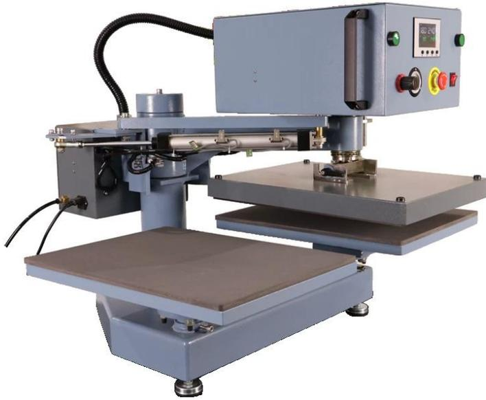
**Sicherheit zuerst:** Verfügt über mehrere Sicherheitsfunktionen, darunter ein Doppelknopf-Steuerungssystem, um die Hände des Bediener vom Pressbereich fernzuhalten, einen Not-Aus-Knopf zum sofortigen Abschalten und einen Mechanismus, der sicherstellt, dass die Heizplatte nur dann funktioniert, wenn sie richtig über dem Untertisch ausgerichtet ist.
