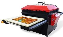
**Doppelarbeitsplatz:** Mit zwei separaten Stationen, die das gleichzeitige Drucken auf zwei verschiedenen Artikeln oder Standorten ermöglichen. Diese Funktion erhöht die Produktivität erheblich.
