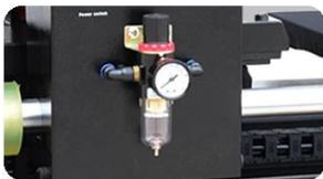
**Luftfilter:** Zum Einstellen des Drucks der APDS-Doppelstations-Heißpressmaschine, einfach zu bedienen und zu warten.
