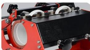
**Super Big Tassenwärmer:** Heizelement für große Tassen, speziell für den Sublimationsdruck von 20-Unzen-, 30-Unzen- und 40-Unzen-Bechern entwickelt. Oder Sie können 2 Stück 11-Unzen- oder 15-Unzen-Becher gleichzeitig übertragen.
