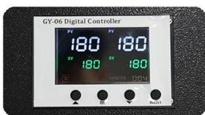
GY-06 数字控制器，用于精确控制热转印的温度和时间。
