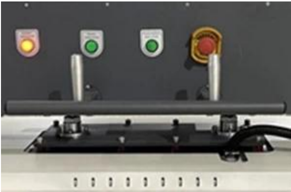
紧急停止按钮 启动按钮 停止按钮 复位按钮
